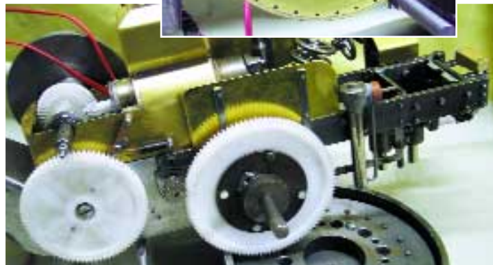
Dieselmotor ist aufgesetzt auf das Getriebegehäuse, links: Zahnrad für Geräusch, rechts: Ritzel und Zahnrad für Antrieb der Hinterwalzen
